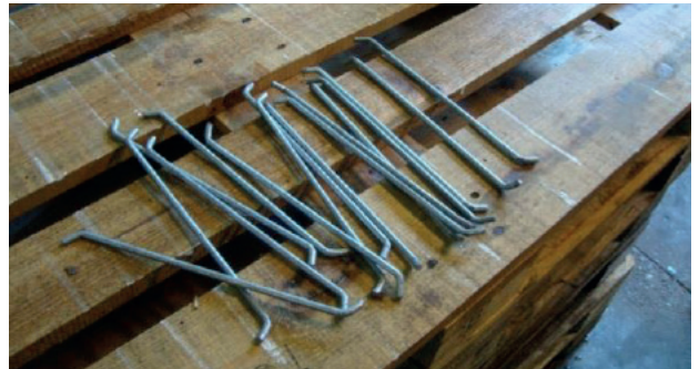
Sperrepinner for å holde dørene i åpen posisjon under montering av gassdempere.
